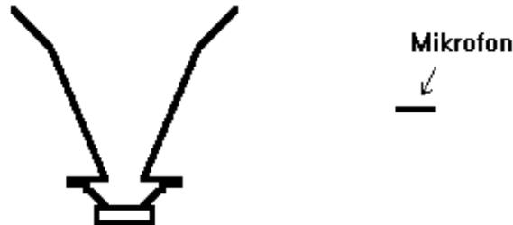
Natürlich ist diese Messung nur im Bereich kugelförmiger Abstrahlung aussagefähig. Dies ist im Bereich tiefer Frequenzen der Fall. Hier nun die Messergebnisse im Vergleich mit der Simulation.
